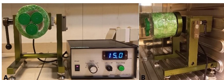
شکل ۱- نحوه قرار گیری نمونه‌ها بر روی دستگاه کلینواستت. A. نحوه قرار گیری نمونه‌ها بر روی صفحه کلینواستت. B. کلینواستت درون انکوباتور.
