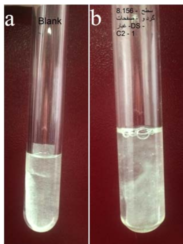
شکل ۳- تصویر a: نمونه شاهد (محیط بدون حضور میکروارگانیسم) که هیچ گونه تخریبی در کاغذ مشاهده نمی‌شود، تصویر b: محیط تلقیح شده با اکتینومیست
