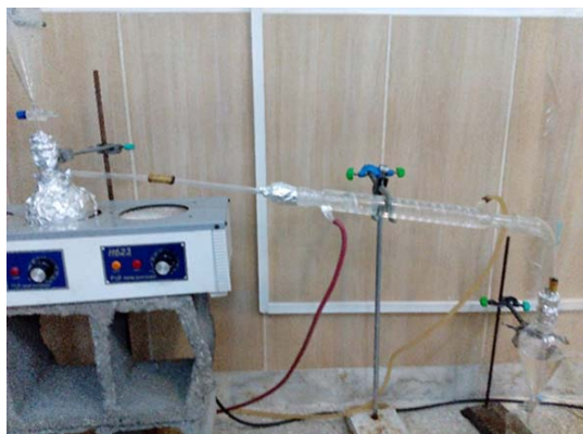
شکل ۱- دستگاه تقطیر مقدار پروتئین طبق روش برادفورد و با استفاده از منحنی استاندارد سرم آلبومین گاوی در طول موج ۵۹۵ نانومتر با دستگاه اسپکتروفتومتر اندازه‌گیری گردید (۱۶ و ۲۱).
