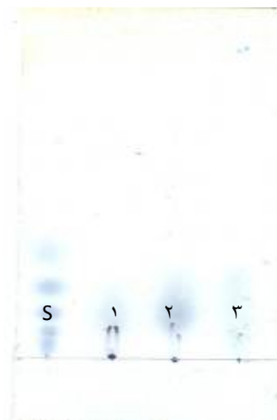
شکل ۵- الگوی فعالیت پولولاناز روی سویستراهای مختلف. محصولات واکنش آنزیمی روی پولولان (خط ۱)، نشاسته محلول (خط ۲)، و مالتوتریوز (خط ۳) با استفاده از TLC مشخص شده‌اند. خط S نشانگر یک مخلوط استاندارد مالتوآلیگوساکاریدها با گستره‌ای از گلوکز G1 تا مالتوہپتانوز GV است.
