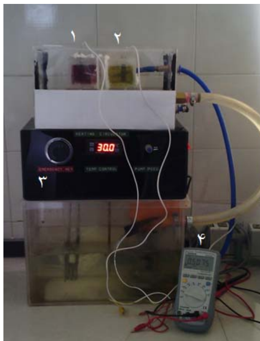
شکل ۱- پیل سوختی میکروبی دومحفظه طراحی شده برای سنجش تولید الکتریسیته. (۱) محفظه آند شامل محیط کشت، باکتری، بافر و نوترال رد؛ (۲) محفظه کاتد شامل بافر و پذیرنده الکترون؛ (۳) حمام آب گرم برای تأمین درجه حرارت مناسب رشد باکتری؛ (۴) مولتی‌متر دیجیتال برای سنجش ولتاژ.
