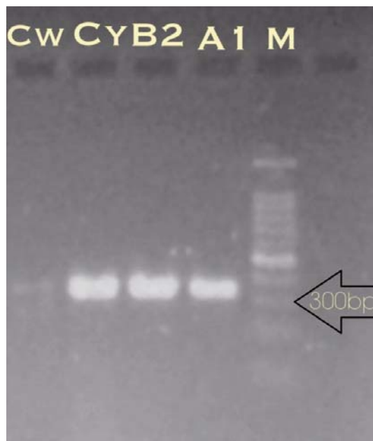
شکل ۱- تشکیل باند ۳۱۸ bp در الکتروفورز محصولات PCR لاکتوباسیلوس پلانتاروم. لاینهای A1, B2, CY و CW؛ ایزوله‌های باکتری، M؛ مارکر 100bp.
